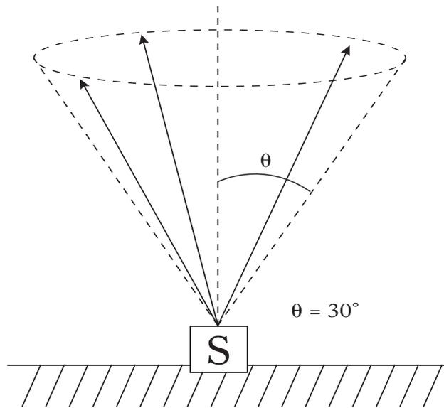
(Fig. 1 : tirs omnidirectionnels libres dans le cône vertical de demi-angle au sommet égal à  $30^\circ$  ; S = source du laser.)
