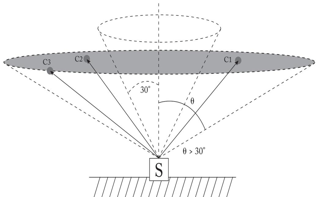
(Fig. 2 : tirs sur cible matérielle fixe opaque et non réfléchissante pour tout rayon formant un angle ( $\theta$ ) supérieure à  $30^\circ$  ; S = source du laser ; C1, C2, C3 = cibles fixes opaque et non réfléchissantes.)
