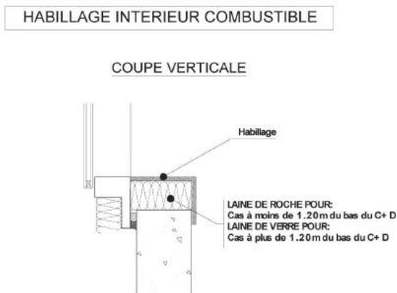
Figure 8 : protection des habillages intérieurs combustibles
